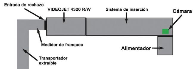
Diseño de ejemplo de sistema de inserción con alimentador, sistema de visión, sistema de lectura/escritura JET MAIL III, medidor de franqueo y transportador extraíble
